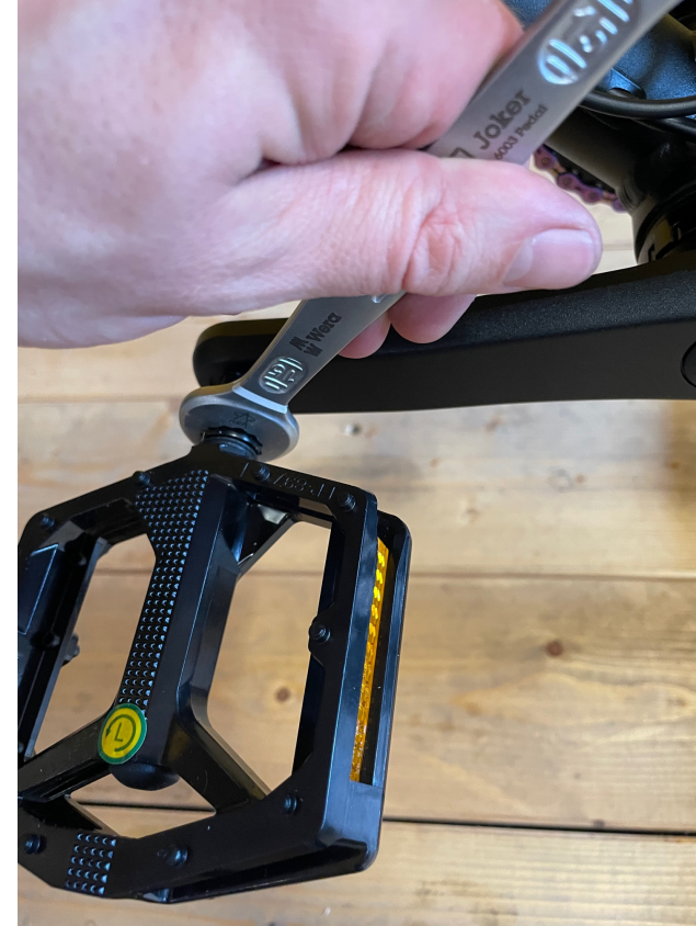
Pedale mit 15 mm Schlüssel anziehen, bis deutlicher Widerstand zu spüren ist. Herstellervorgabe: 40 Nm Anzugsmoment.
