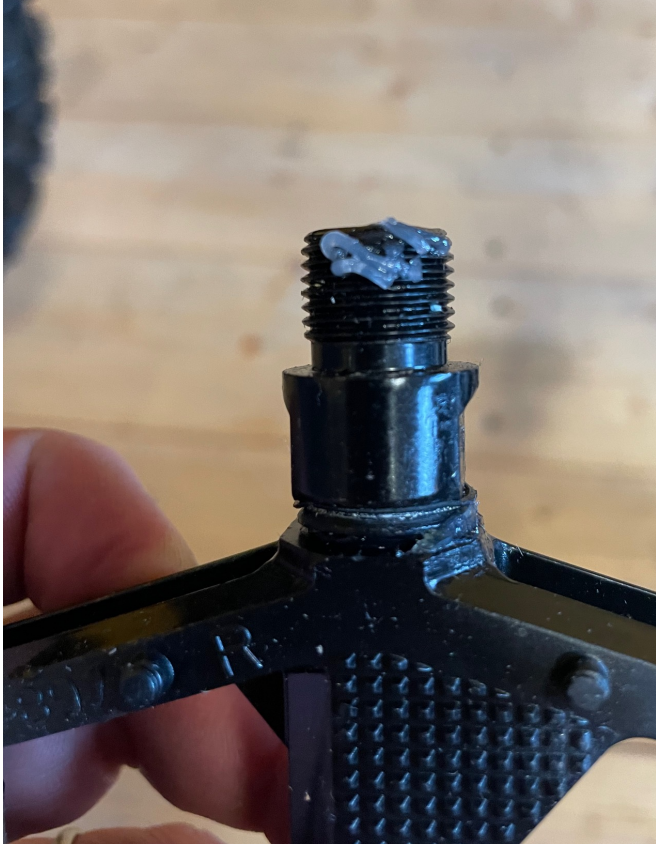
Gewinde mit etwas Fett schmieren
