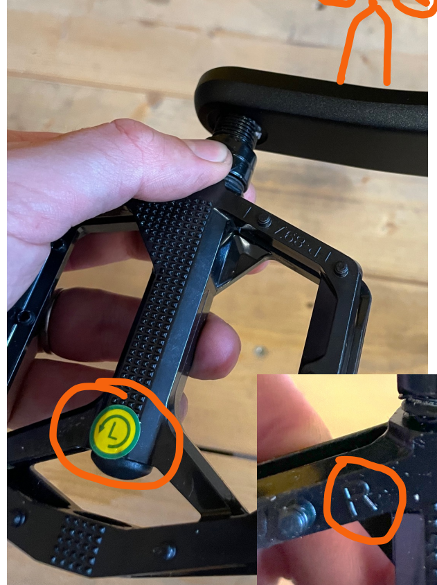
Pedale: links und rechts beachten. Markierungen befinden sich auf dem Pedal
