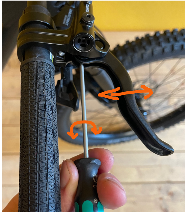
Bremsgriffweite mit einem Sechskantschlüssel 2 mm in eine angenehme Griffweite bringen
