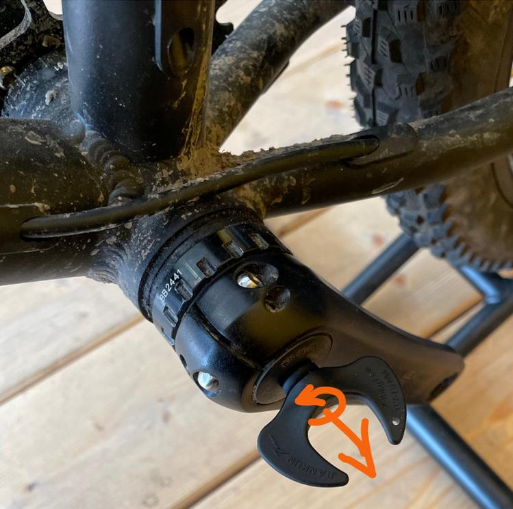
Kurbelsicherung (Kurbelschraube) mit mitgeliefertem Werkzeug komplett rausdrehen (nicht wegschmeißen!)
