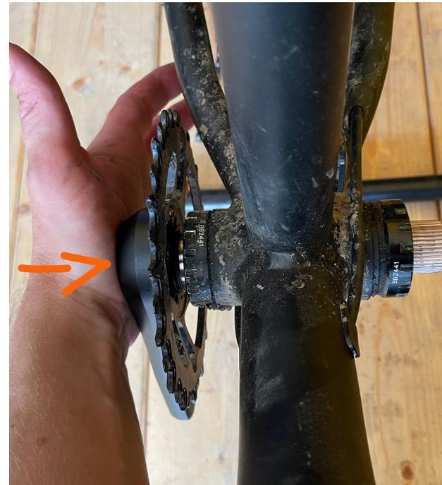
Einsetzen und ggf. mit druck durch Handballen nachhelfen.
