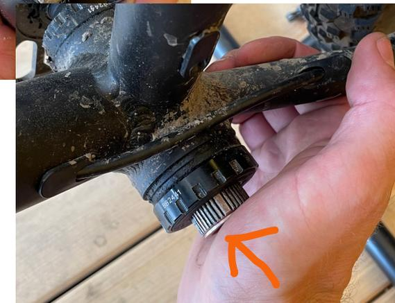
Kurbelarm entfernen und Kurbel über Achse aus Tretlager schieben.
