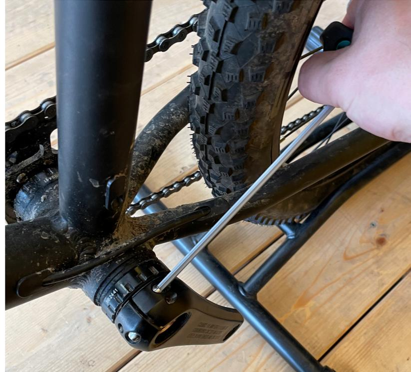
Klemmschrauben mit Innensechskant (4 mm) lösen / lockern, nicht rausdrehen
